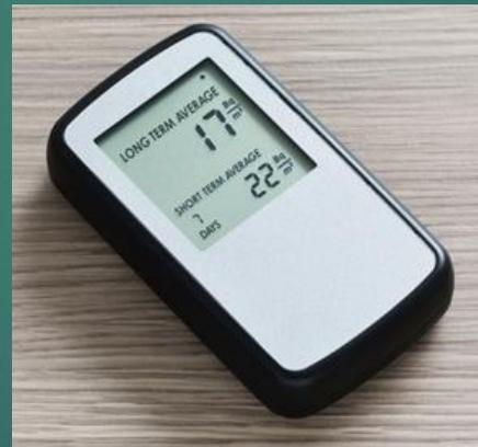
Una prova Radon continua NON è automaticamente una prova attiva. E' utile sottolineare il fatto che molti strumenti elettronici sono passivi in cui cioè il Radon entra nella camera di misura per diffusione.
